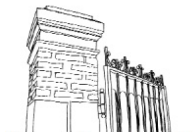
Pilier avec un chapeau en pierre de taille, ferronnerie sobre
