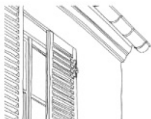
Feuillure dans laquelle s'encastre un volet à claire-voie (qui laisse passer le jour)
