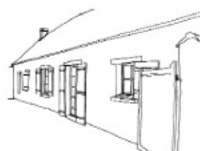
Les percements sont inscrits aléatoirement dans la façade mais les linteaux sont alignés
