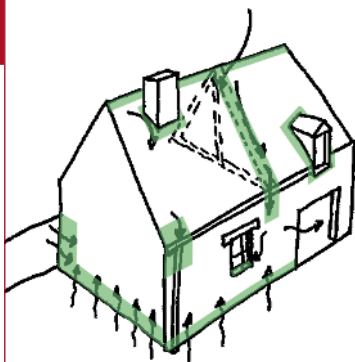
Croquis de localisation des désordres provoquant la présence d'humidité.
